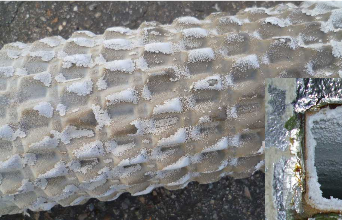
Versintertes \text{SiO}_2 auf Rekuperator
