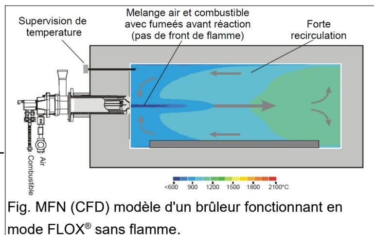
2. L'absence de flamme permet une conversion constante et robuste des combustibles gazeux, totalement indépendante de la qualité du gaz, telle que la fluctuation du pouvoir calorifique. La robustesse de FLOX® est adaptée à une large gamme de gaz spéciaux.
